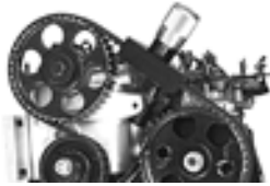
Medición de la tensión de la correa
